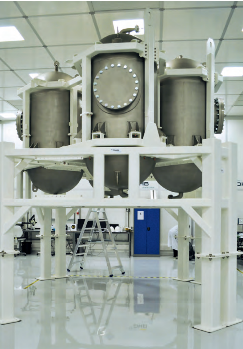
Treibstofftanks für das Orion European Service Module im Reinraum von OHB Sweden
