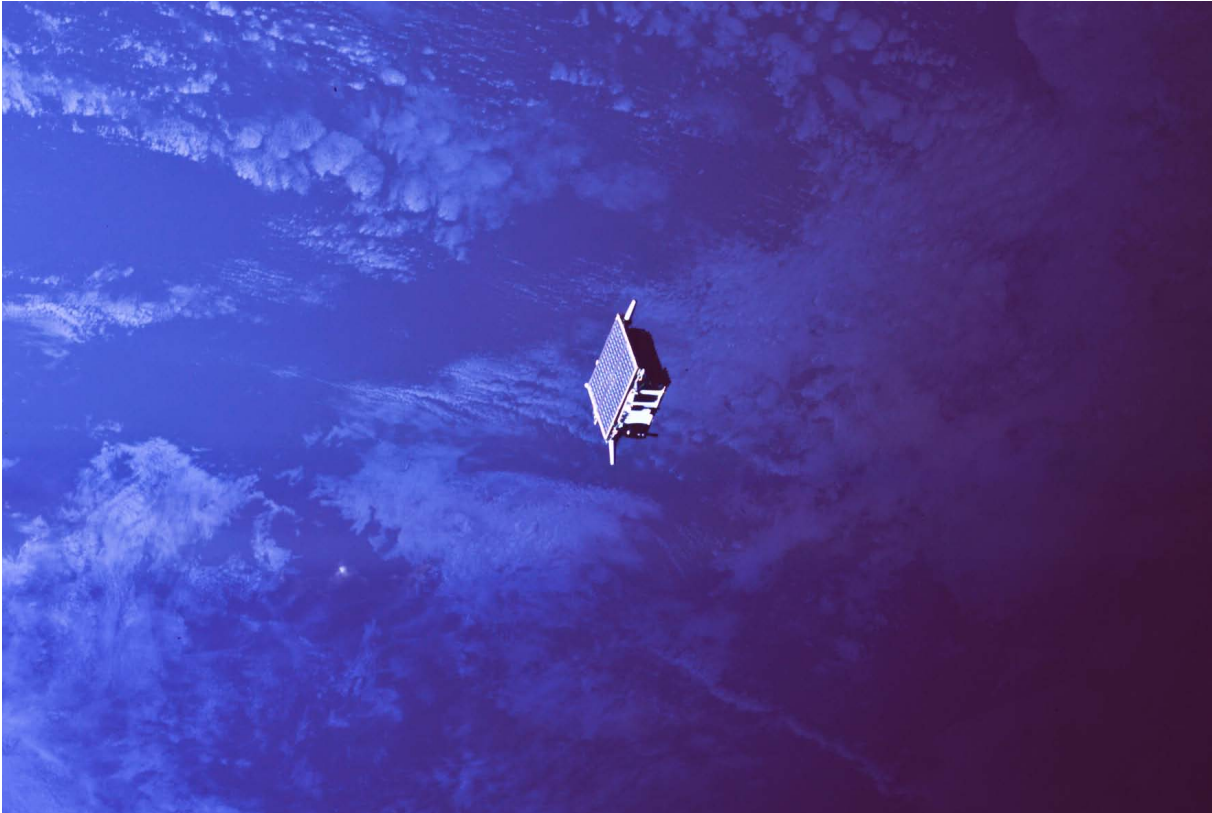
Foto des von OHB Sweden entwickelten PRISMA-Satelliten „Tango“, aufgenommen vom zweiten Satelliten „Mango“ bei einer Annäherung auf 10 Meter im Rahmen eines Formation Flying Experiments
